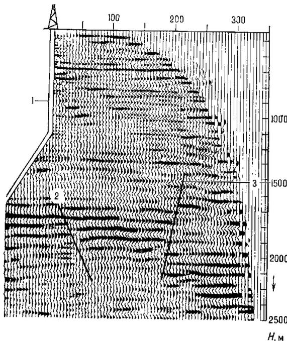
Глубинный сейсмический разрез (Прибалтика), полученный путем преобразования записей ВСП: 1 — буровая скважина, в которой проводился исследование; 2 — положение нефтеносных отложений кембрийского возраста; 3 — зоны тектонических нарушений.
